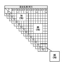
※注意 1:外径の注意点 2.5mm内寄せになっています ・外径75mm→有効径80mm ・外径70mm→有効径75mm ・外径65mm→有効径70mm
