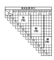
※注意 1 : 外径の注意点 2.5mm内寄せになっています ・外径70mm→有効径75mm ・外径65mm→有効径70mm
