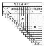
※注意1:外径の注意点 2.5mm内寄せになっています ・外径70mm→有効径75mm ・外径65mm→有効径70mm
